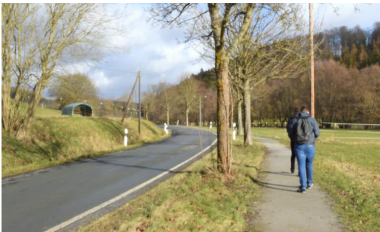
Abbildung 8: Außerortsstraße (links) entspricht nach der Breite nicht den aktuellen Regelwerken, aber den örtlichen Anforderungen
