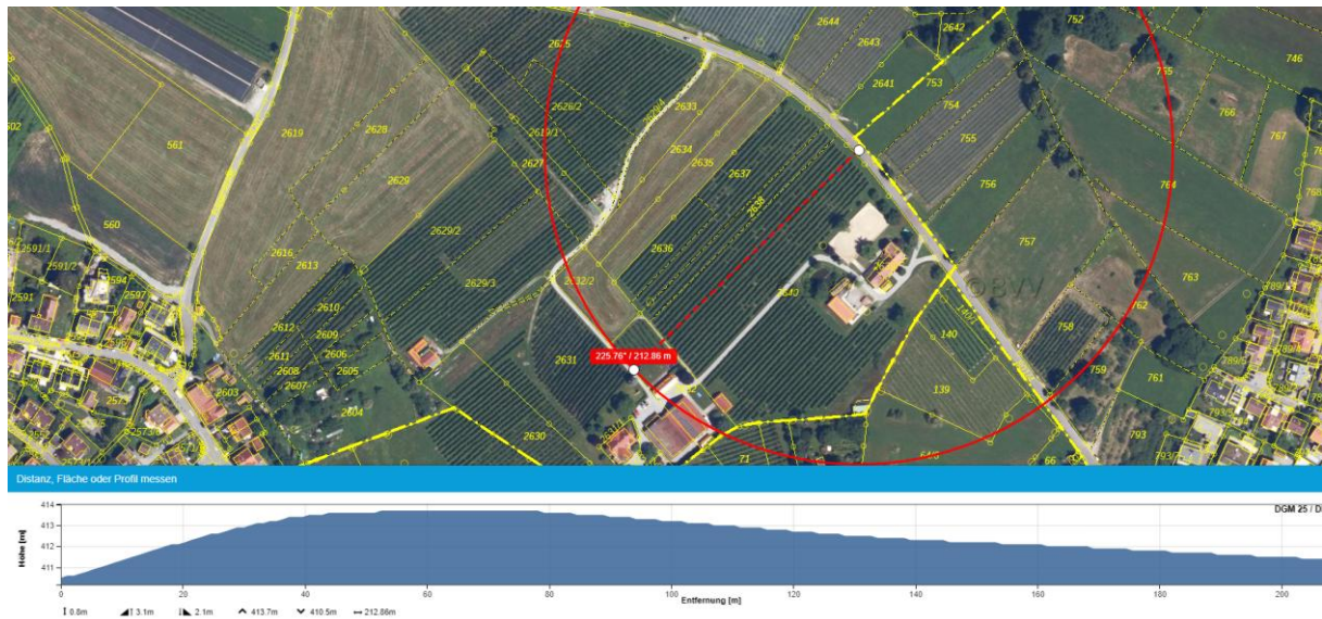
Abbildung 7: Geländeschnitt von Nordosten nach Südwesten (Quelle: BayernAtlas)
